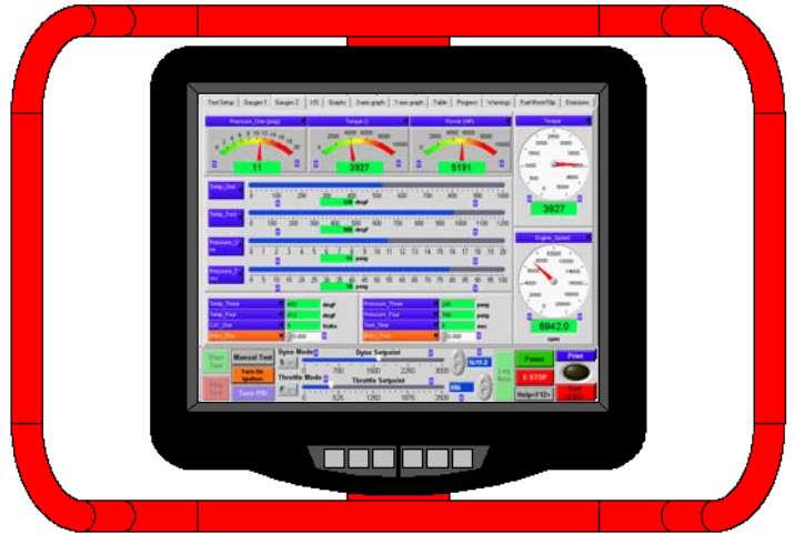
Ручной пульт управления с цветным сенсорным экраном размером 7 1/4" x 9 3/4" (18,4 см x 24,8 см)
