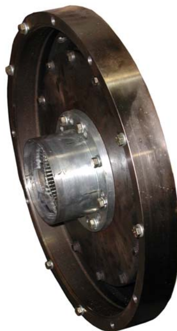
飞轮上的驱动联轴器
